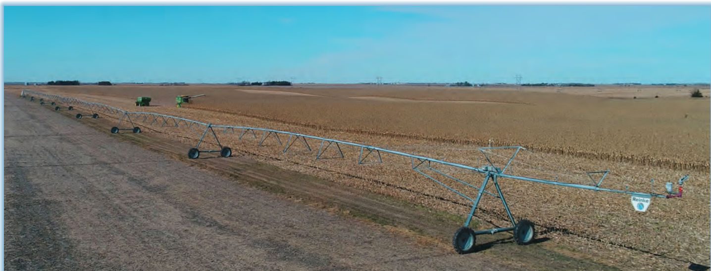
Припаркуйте дождевальную систему параллельно направлению преобладающих зимних ветров и засыпьте все колесные колеи.
